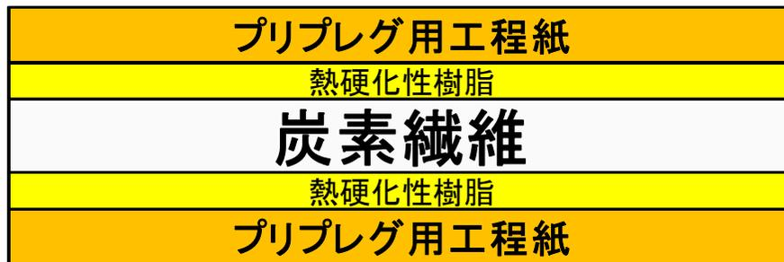
熱硬化性樹脂を塗工したプリプレグ用工程紙で炭素繊維を挟み込み、樹脂を含浸させる
